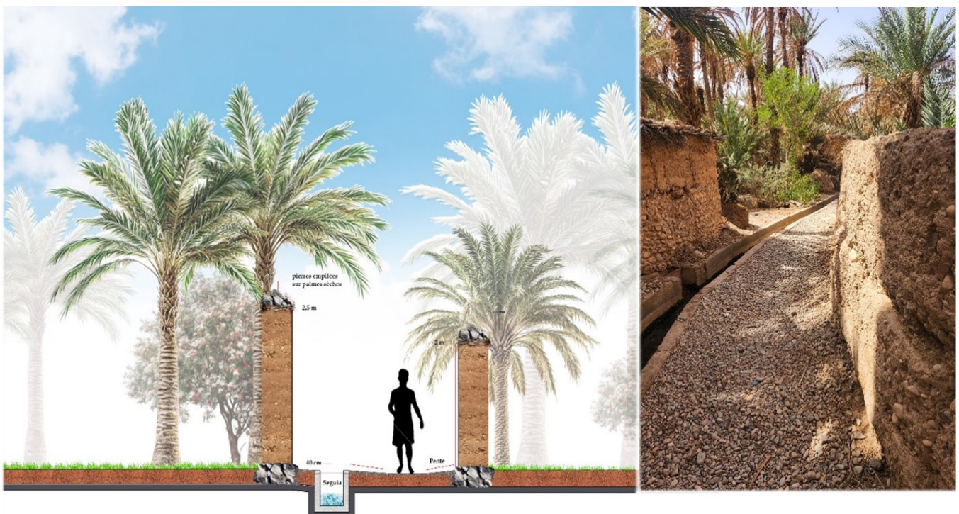
Figure 9: Coupe schématique et photo de murs en pisé à l'intérieur de l'oasis de Fam Al Hisn
