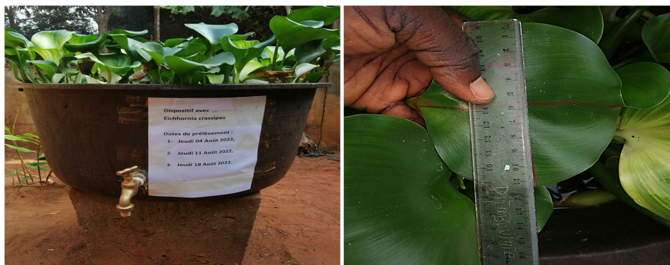
Figure 2: a) Dispositif expérimental avec E. crassipes ; b) Mesure de la largeur d la feuille
